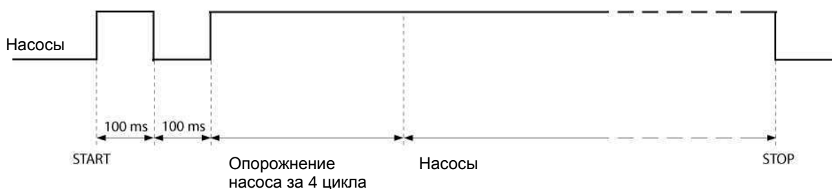
Диаграмма синхронизации - Соединение через Control/PLC 2.1
